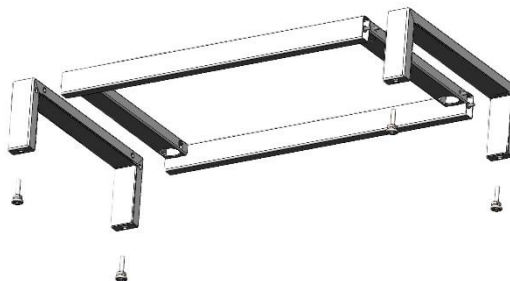
Рис. 1. Сборка высокого каркаса
